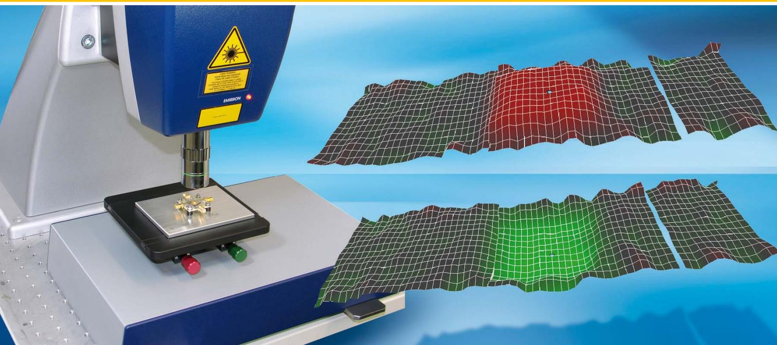
基于激光多普勒原理的 Polytec 激光测振仪，设备核心为一台高精度激光干涉仪，输出激光照射到待测目标上，同时收集目标反射激光，经干涉产生正比于目标速度的多普勒频移信号，经内置于控制器内的解码器运算处理，输出被测物的速度值和位移值。
